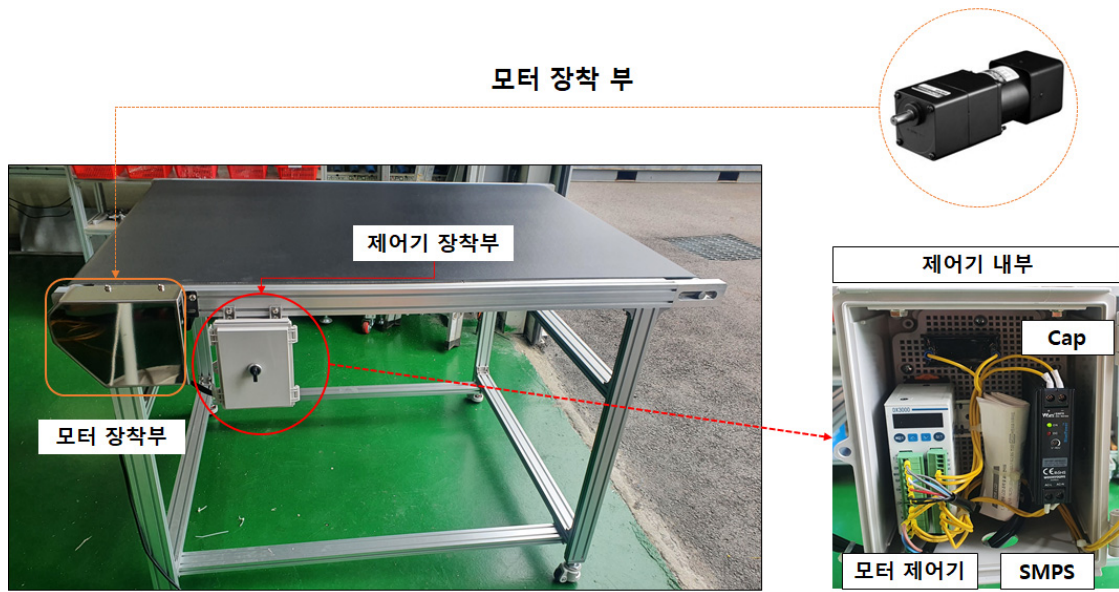
그림 11. 시험용기 이송용 컨베이어 벨트 구성.
